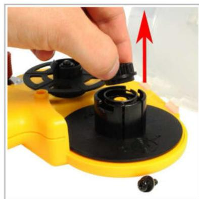
Die Halterungsfeder durch Anheben entfernen.
