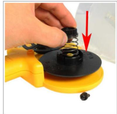
Das Arretierungsrad herunterdrücken, durch Drehen in die Passform einrasten lassen.
