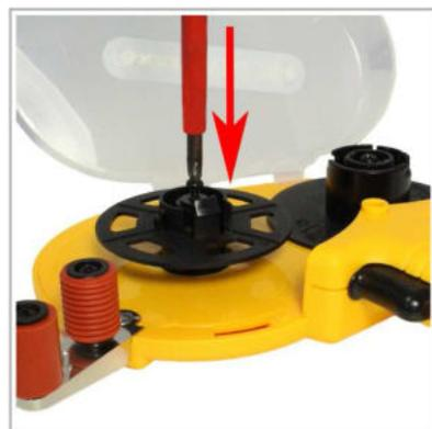
Die Befestigungsschraube der rechten schwarzen Spule (Trägerpapierspule) mit einem Schraubenzieher lösen.
