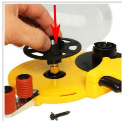
Die Befestigungsschraube mit einem Schraubenzieher wieder eindrehen.
