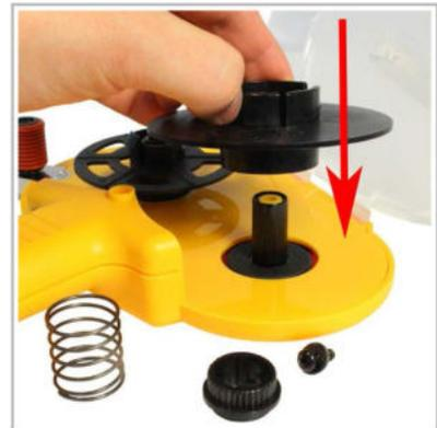
Das Arretierungsrad auf die Halterungsfeder legen, beide Teile mittig auf die Spulenhalterung setzen.
